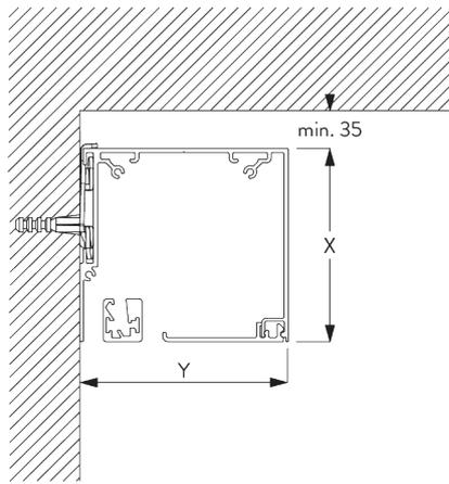
**Boîtier S avec bride SG 3044 / Boîtier L avec bride SG 11180**
