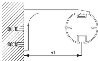
Vis SG 10492 (M4x8) nécessaire.
