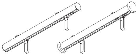
Sans embouts décoratifs, les profils sont fournis en standard avec l'embout Flush SG 20346 (gauche).
