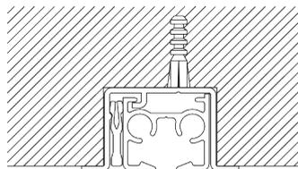
Une cale de blocage SG 10157 par point de fixation
