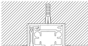
Une cale de blocage SG 5118 par point de fixation.
